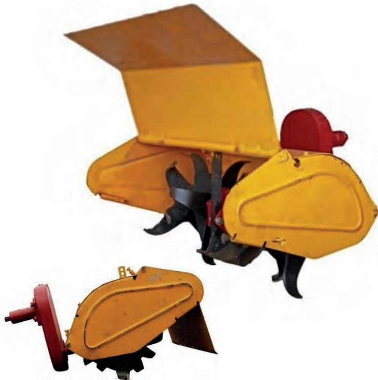
Фреза почвенная ФНМ-1 предназначена для обработки почвы в садах и огородах колективного и индивидуального пользования.
