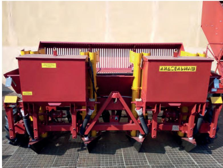
Предназначена для рядковой посадки непророщенных клубней картофеля. Картофелесажалка состоит из следующих основных узлов: рамы, опорно-приводных колес, высаживающих аппаратов, сошников, бороздозакрывателей, загрузочного бункера, редуктора изменения густоты посадки. Оборудована туковысыевающими аппаратами для минеральных удобрений.
