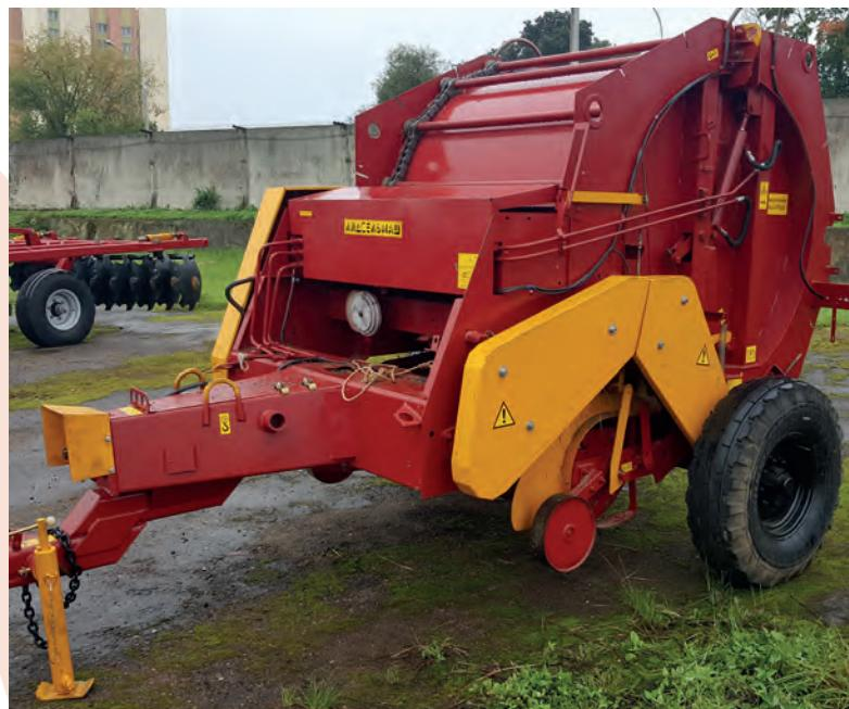
Предназначен для подборки валков сена естественных и сезонных трав или соломы, прессования их в тюки цилиндрической формы (рулоны) с одновременной обмоткой шпагатом.
