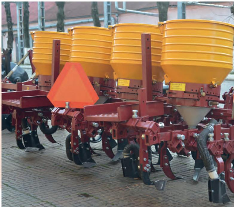
Предназначен для междурядной обработки хлопчатника и других высокостебельных культур в период вегетации, посаженных 4-рядными сеялками.
