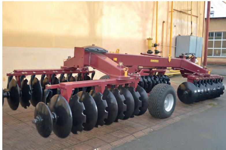
Предназначена для рыхления и подготовки тяжелых и средних почв под посев, уничтожения сорняков и измельчения пожнивных остатков, для разделки пластов почвы, поднятых кустарниково-болотными плугами или после вспашки целинных земель, для предпосевной подготовки почвы без предварительной вспашки и обработки почвы после уборки толстостебельных пропашных культур, а также для ухода за лугами и пастбищами, засоренными мелкими камнями размером не более 10 см и древесными остатками толщиной до 2 см.
