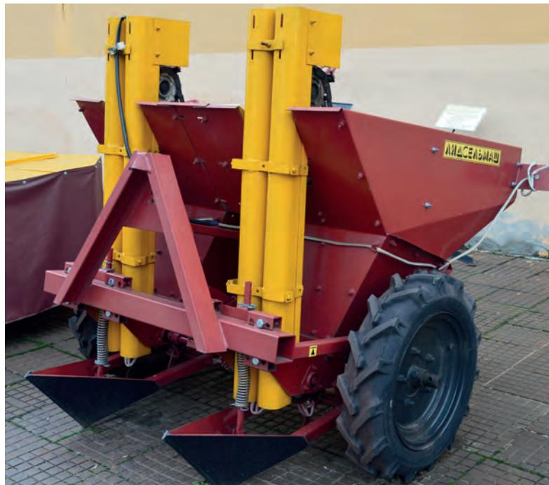
Предназначена для рядковой посадки непророщенных клубней картофеля на мелкоконтурных участках. Картофелесажалка состоит из следующих основных узлов: рама, опорно-приводных колес, высаживающих аппаратов, сошников, бороздозакрывателей, загрузочного бункера, редуктора изменения густоты посадки. Картофелесажалка проста и удобна при обслуживании и регулировках.
