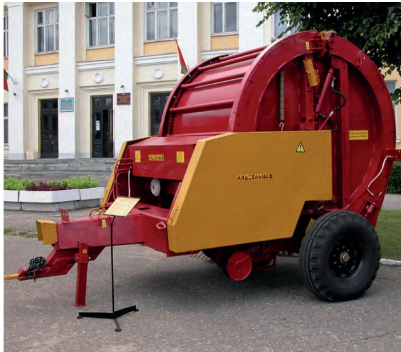
Предназначен для подбора валков сена естественных и сеяных трав или соломы, прессования их в тюки цилиндрической формы (рулоны) с одновременной обмоткой шпагатом. ППР - Ф - 1,8-01 агрегатируется с тракторами тягового класса 2.
