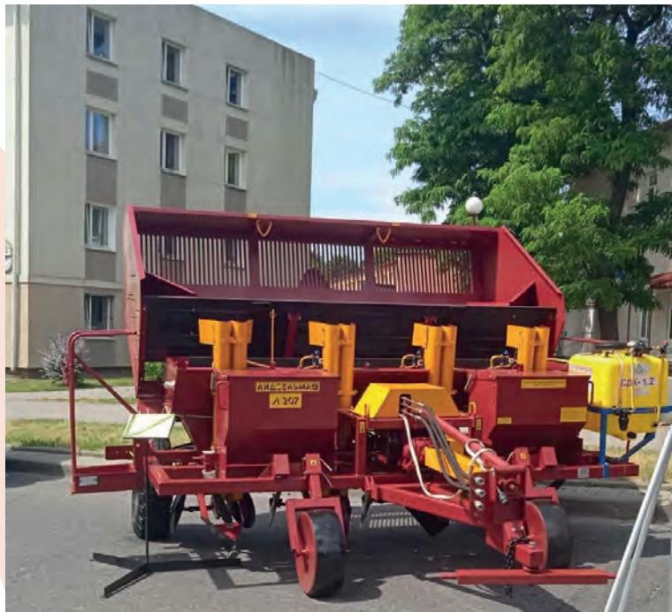
Картофелесажалка предназначена для рядковой посадки непророщенных клубней картофеля с междуурядьями 70, 75 или 90 см. Картофелесажалка агрегатируется с тракторами тягового класса 1,4. Загрузка картофелесажалки картофелем производится из любых самосвальных транспортных средств. Картофелесажалка оборудована туковысыевающими аппаратами.
