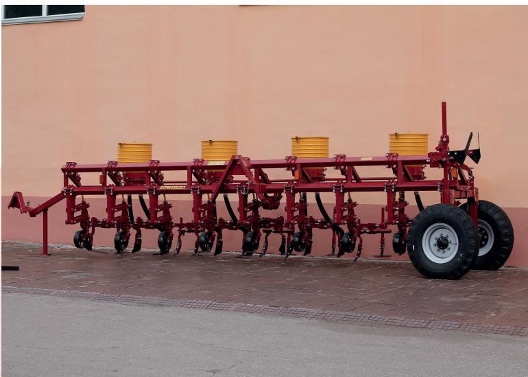
Культиватор КУП-5,6 предназначен для междурядной обработки и подкормки 8-рядных посевов кукурузы, подсолнечника, клещевины и других высокостебельных пропашных культур, посаженных с междурядьями 60, 70 см.
