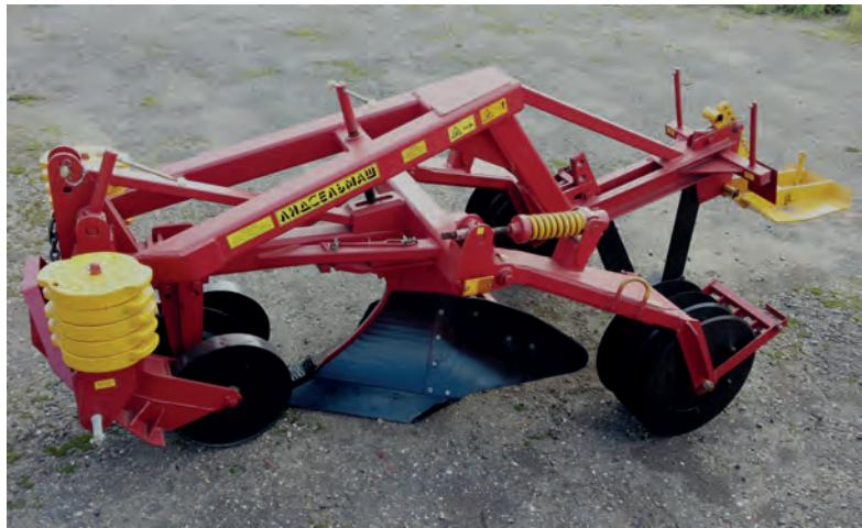
Плуг предназначен для подготовки почвы в виде борозд под посадку лесных культур на непокрытых лесом землях различной степени задернения и на раскорчеванных вырубках, очищенных от порубочных остатков и обеспечивающих проходимость машинно-тракторного агрегата, а также по расчищенным полосам шириной от 3,5 до 4,0 м.
