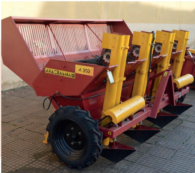
Предназначена для рядковой посадки непророщенных клубней картофеля. Картофелесажалка состоит из следующих основных узлов: рамы, опорно-приводных колес, высаживающих аппаратов элеваторного типа, сошников, бороздозакрывателей, загрузочного бункера и редуктора изменения густоты посадки. Машина проста и удобна при обслуживании и регулировках.
