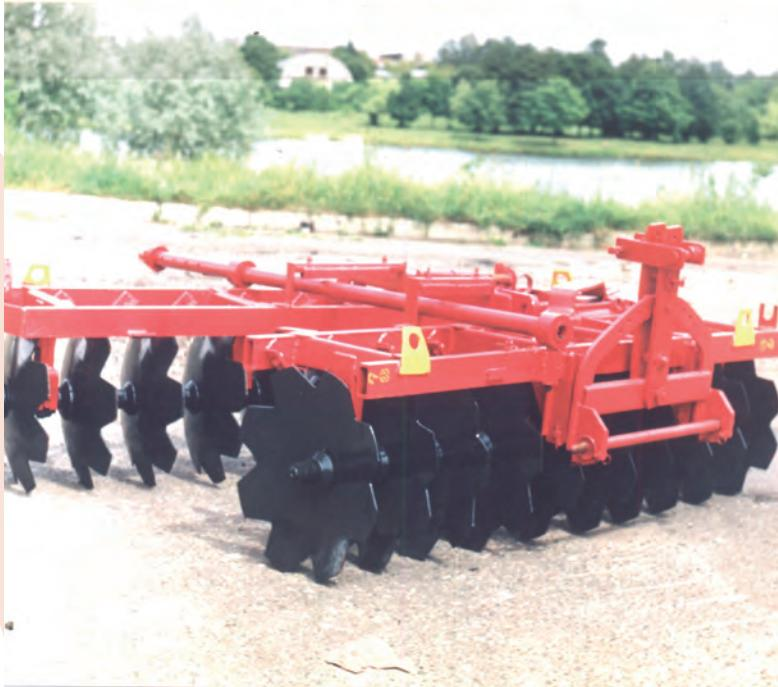
Предназначена для глубокого рыхления почвы и уничтожения сорняков в междурядьях садов. В рабочем положении борона является прицепным орудием, а для дальнего транспортирования переналаживается и навешивается на трактор. Борона может использоваться для сплошной обработки полей. Борона не предназначена для работы на каменистых почвах.
