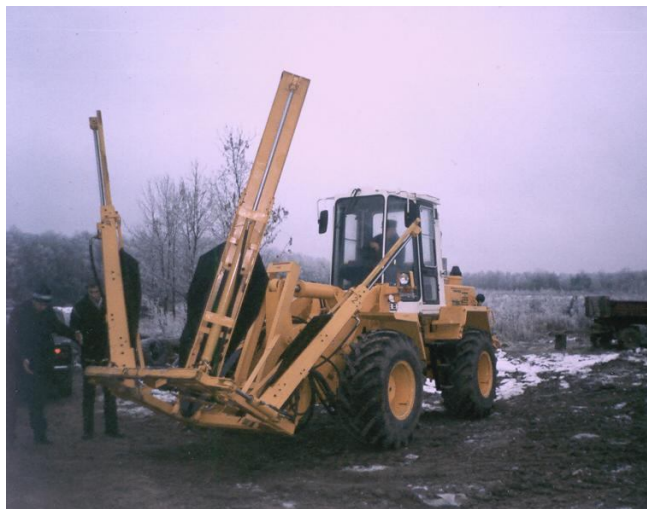
Рис. 1. Машина для пересадки деревьев с комом земли в одном из отделений зеленого хозяйства г.Москвы.
