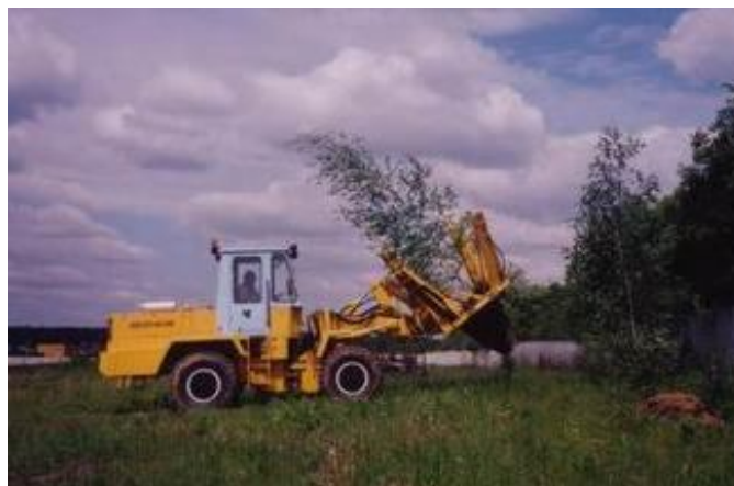
Рис. 7. Перемещение выкопанного дерева погрузчиком при «челночном» цикле работы
