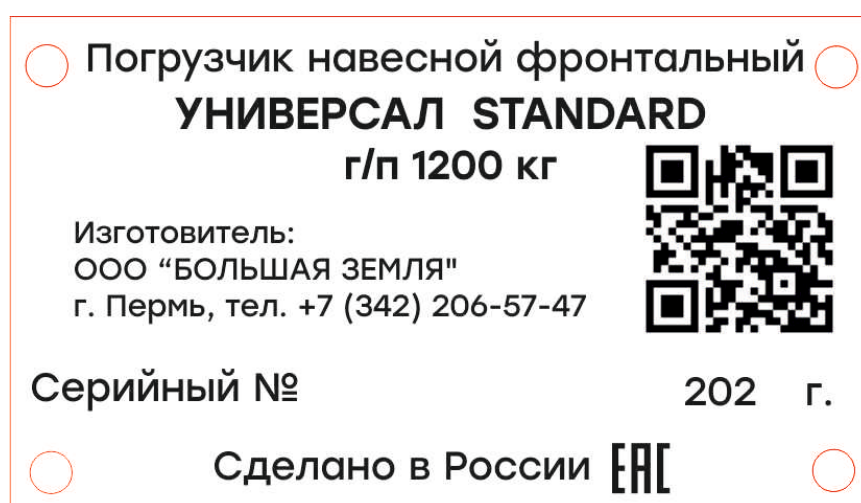
Рис. 1.27 – Паспортная табличка для погрузчиков
