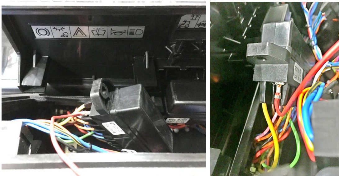
Рис. 4.3.24 – Подключение жгута кабины к питанию
